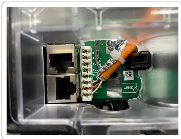
Abbildung 3. LAN 2 Port über LSA+ Klemme
